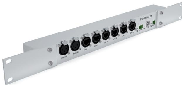
Der **Pan Splitter 2/6** ist ein Pan Net Interface mit Hub-Funktion, das über sechs Pan Net-Ausgänge verfügt. Die zwei Audioeingänge des Interfaces stehen allen sechs Pan Net-Ausgängen zur Verfügung. Pro Pan Net-Ausgang können mehrere Linienstrahler aus der Pan Beam Serie betrieben werden. Zudem verfügt der Pan Splitter 2/6 über einen Alarmkontakt und einen Anschluss zur Mediensteuerung (Umschalten von Presets).
