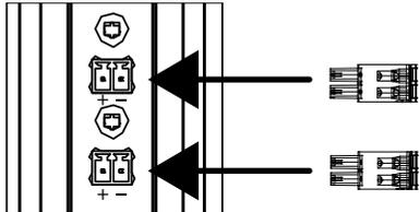
Die zwei-poligen Anschlüsse sind parallel geschaltet für den Anschluss weiterer Lautsprecher auf der Linie.
