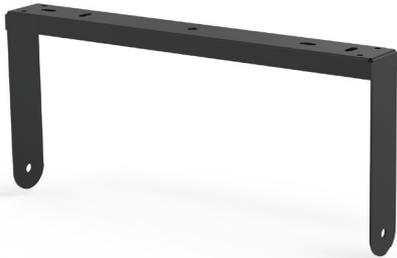
Der **Schwenkbügel, P 8-CX** ermöglicht die Verwendung der CX-Lautsprecher aus der Pan Speaker Serie an Traversen, Prospektzügen oder Laststangen. Für die Montage, z.B. eines Half-Couplers, verfügt der Bügel über eine mittige Bohrung [Ø 11mm]. Alternativ kann der Bügel auch direkt an Decken oder an Wänden mittels Schraub-Dübelverbindung befestigt werden.
