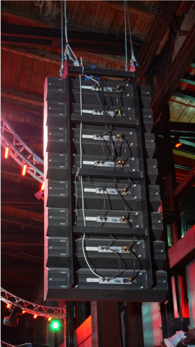
Einzelnes Pan Beam Arrayelement als Delaysystem
