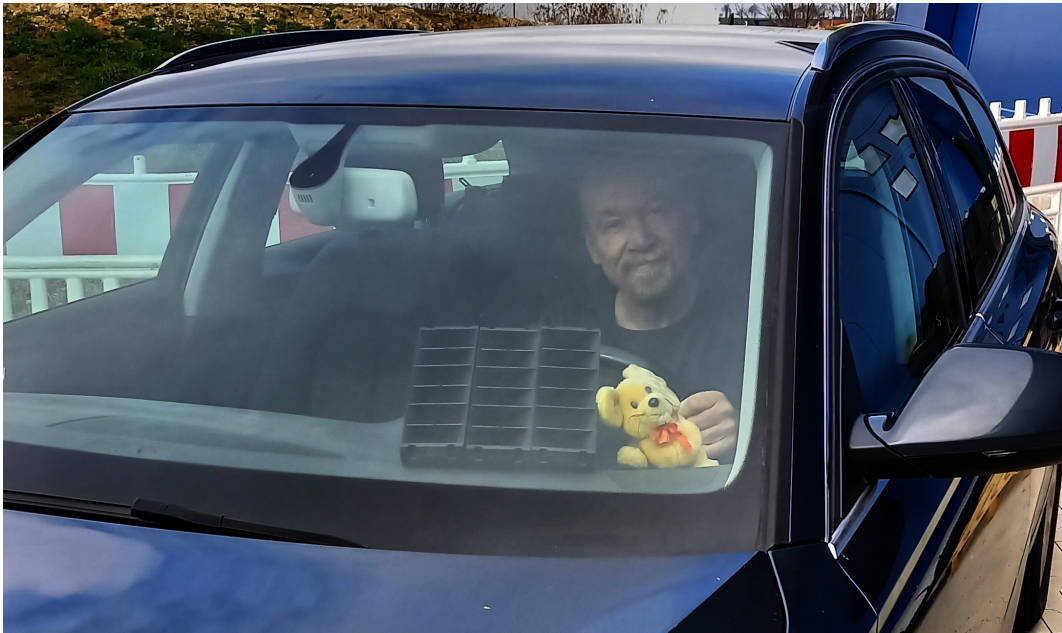
Der Funktransponder auf dem Armaturenbrett schickt Signale an die Ampel-Elektronik.
